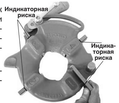
Рис. 8 – Вставка резьбонарезных гребенок
