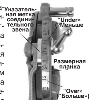
Рис. 9 – Настройка размера резьбы
