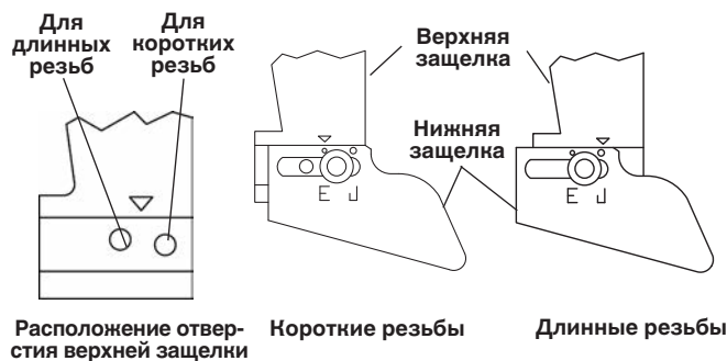
Рис. 18 – Настройка длины резьбы
