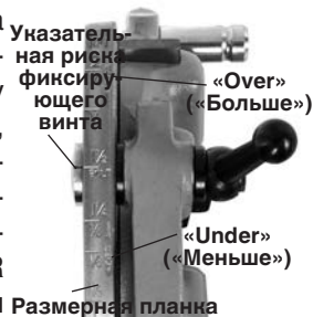
Рис. 13 – Настройка размера резьбы
