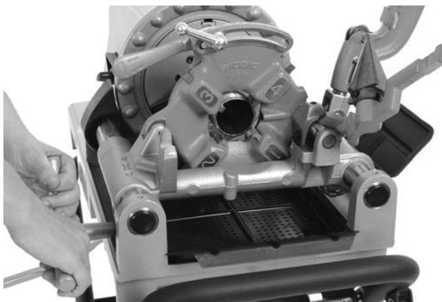
Figure 24 – Filetage des tuyaux (ici, à l'aide d'une tête de filière à ouverture rapide)
